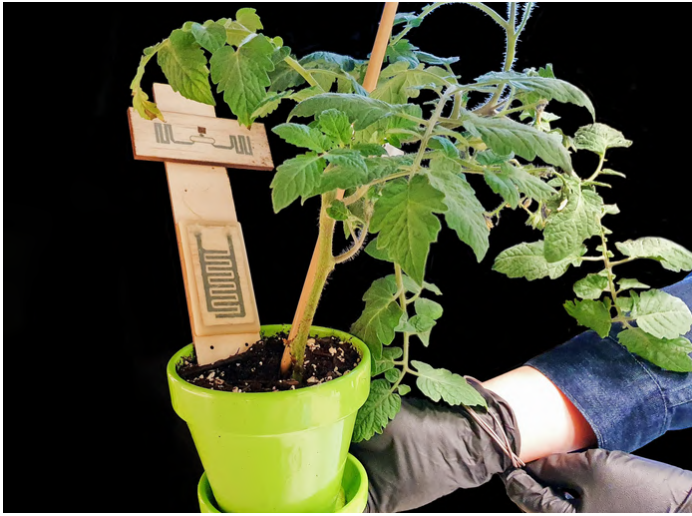
جهاز استشعار للتربة مطبوع بأبعاد ثلاثية قابل للتحلل الحيوي أنشئ في جامعة كولورادو ، بولدر.
