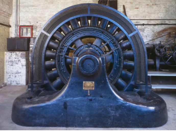
مولدات التيار المتردد بقدرة 750 كيلو وات وارتفاع 2.6 متر والتي تم استخدامها في محطة فولسوم.
